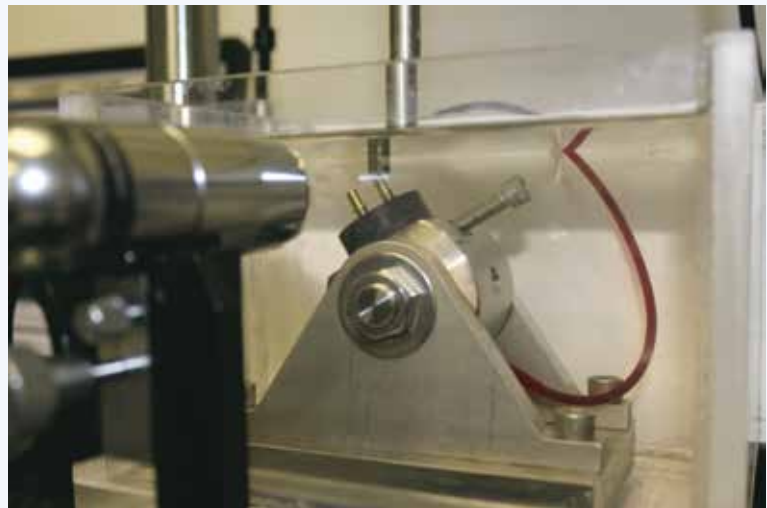
試験システムを電気力学的試験機(水槽付き)にマウントした
